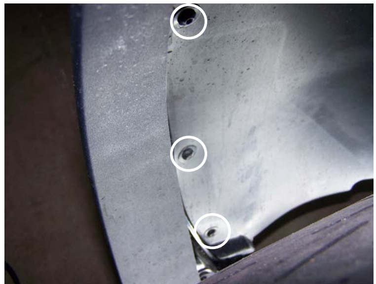
Remove Screws (3 Per Side)
